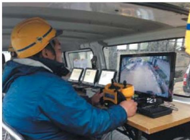
CONDOR映像を利用した遠隔操作状況
