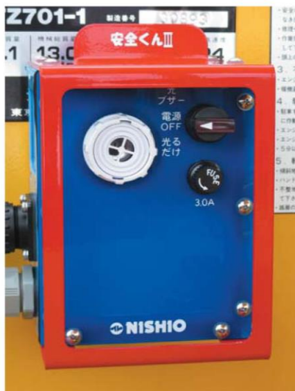
コントローラ部
